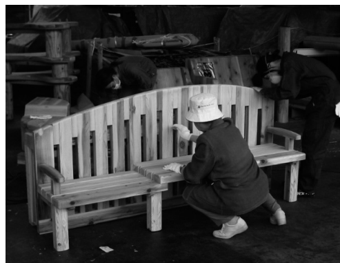
写真 6, 7. ベンチ仕上げ作業
