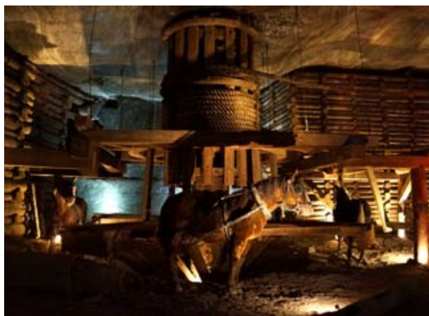
写真 36 馬力による巻き上げ機 [2013.8.28 筆者撮影]
