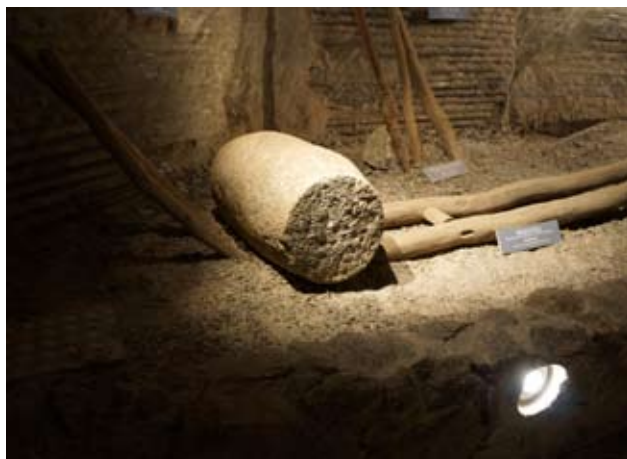
写真 25 樽型に切り出した岩塩 木製レール上を転がす [2013.8.28 筆者撮影]
