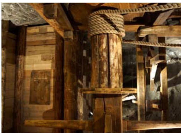
写真7 人力の手回し巻き上げ機 [2013.8.28 筆者撮影]
