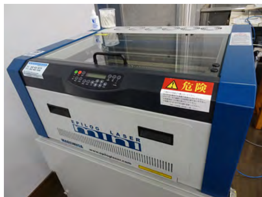
図1 小型レーザーカッター
