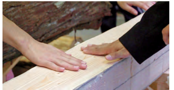
写真31 仕上げ肌の確認
